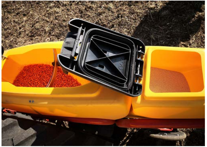
Applikation von EasyStart® TE-Max; links: Saatgut, rechts: Mikrogranulatbehälter
